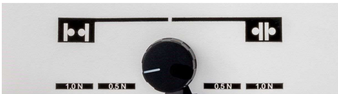
Abb. 22: Messkraftbereiche für Außen- und Innenmessung
