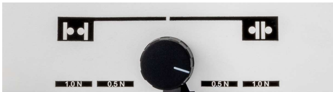
Abb. 16: Messkraftbereiche für Außen- und Innenmessung
