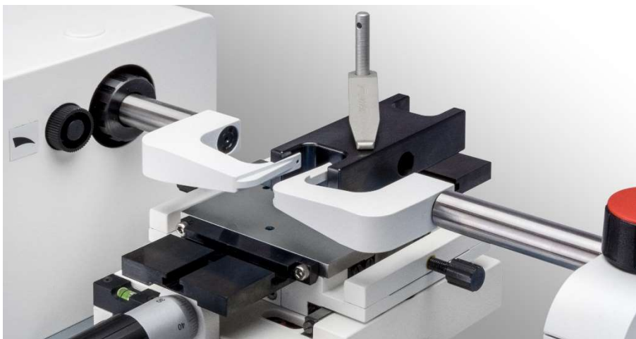
Abb. 25: Messung von Messobjekten mit senkrechten Messflächen oder horizontal liegenden Bohrungen
