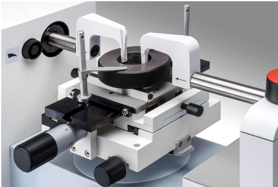
Abb. 24: Messung von Messobjekten mit großen Durchmesser
