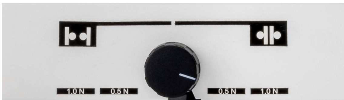
Abb. 6: Messbereiche für Innen- und Außenmessung
