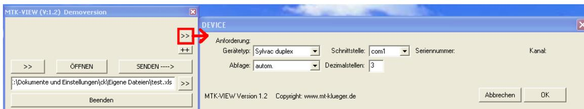
Abhängig vom Gerätetyp werden weitere Auswahlfelder (Schnittstelle, Seriennummer und Messkanal) sichtbar. Es werden -die auf dem PC aktuell verfügbaren- seriellen Schnittstellen automatisch in der Liste dargestellt. Bei USB Geräten wird die Liste mit den Seriennummern ermittelt.
